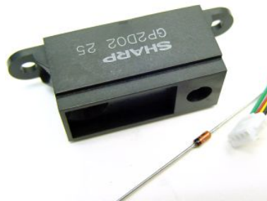
Figura 6.4: el GP2D02 de Sharp mide distancias por infrarrojos.
