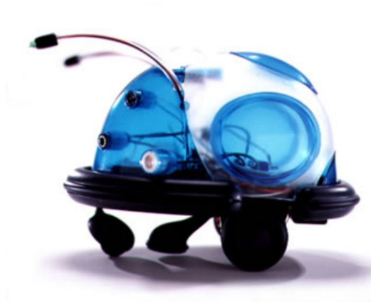
Figura 2.5: Cybot, microbot del que aprovechamos la plataforma.
