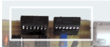
Figura 8.9: Detalle de los chips con la puerta lógica AND y los amplificadores
