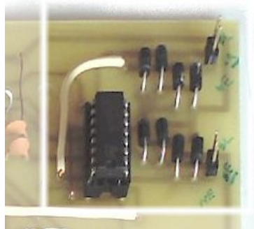
Figura 8.5: Detalle del driver del motor y los diodos de protección
