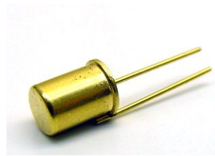
Figura 6.5: Sensores de mercurio, permiten saber si el robot se inclino a un determinado ángulo.
