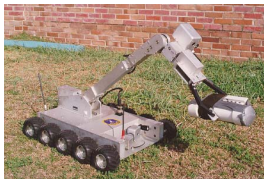
Figura 3.6: Robot de 10 ruedas para mejorar la estabilidad
