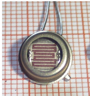
Figura 6.2: Las LDR(Resistencias Dependientes de la Luz) se utilizan como sensores.
