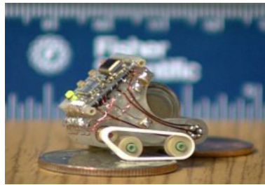
Figura 1.2: MARV mide solo 12 mm. de altura.
